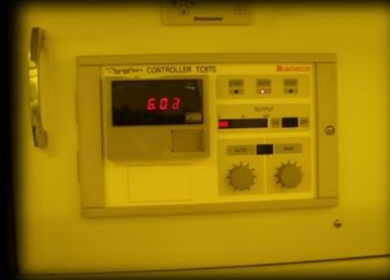
張力制御 Tension Controller 50 ~ 70 N
